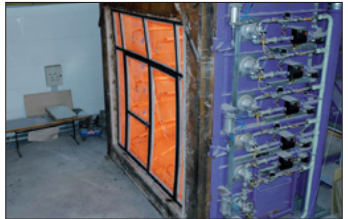
Brandtest av dubbeldörr med sido- och ovanljus för brandklass E 60
