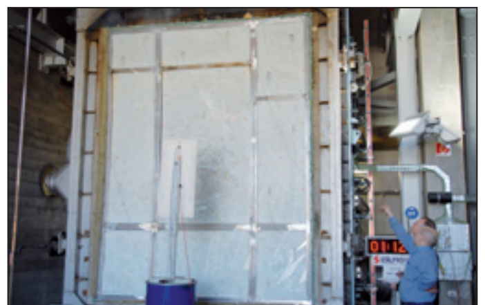
Brandtest av 4 m högt väggparti med "free edge" för brandklass EI 60 enligt EN
