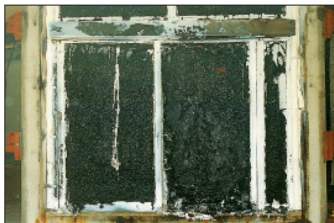
Brandsidan av skjutdörr efter genomförd brandtest
