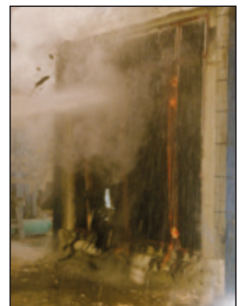
"Hose stream" test av dörrparti efter EI 90 (motsv) brandtest för USA
