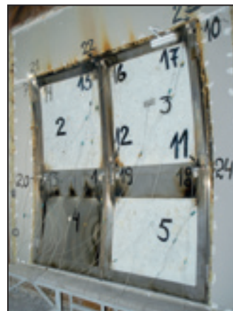
Brandtest av dubbeldörr med tex skruvbara gångjärn, brett mittband, mm
