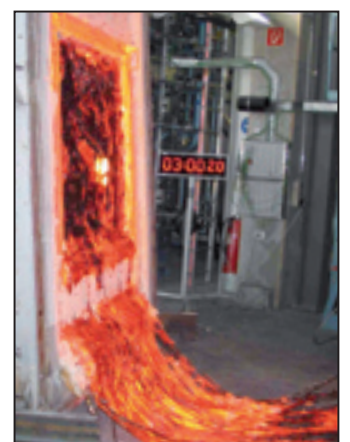
Objektsprovning för brandklass EI 180 (motsv) på väg till "hose stream"
